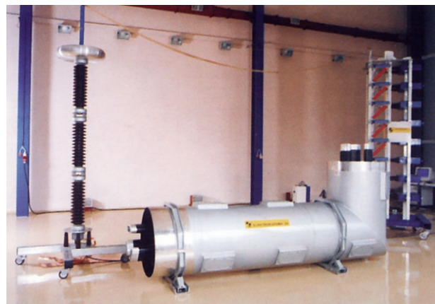
Badanie szynoprzewodu w zakładowym laboratorium wysokich napięć Testing the busducts in the Company's high-voltage laboratory
